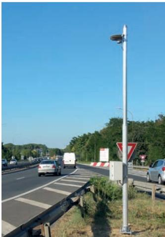
**Capteur de détection de gabarit D523**
