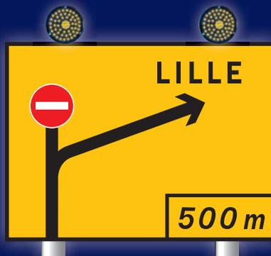
Les optiques sont placées au-dessus du signal.
