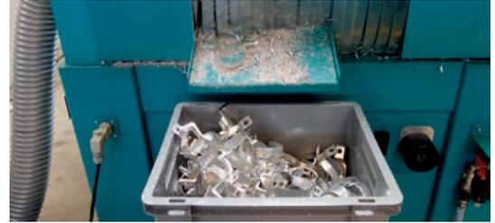
Les copeaux d'aluminium sont soigneusement triés pour être recyclés dans une filière spécifique.
