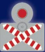
Le feu R24 permet de signaler un arrêt obligatoire (Passage à niveau, passage de tramway,...)
