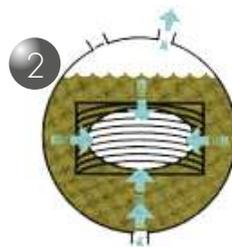
Autoclave rempli, sous vide, avec la solution de traitement TANALITHE®
